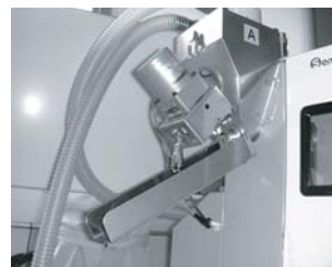
ホッパー内原料抜き取り
