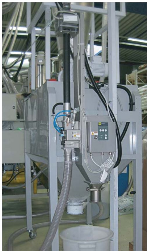
垂直搬送パイプラインに設置された金属選別機GF
