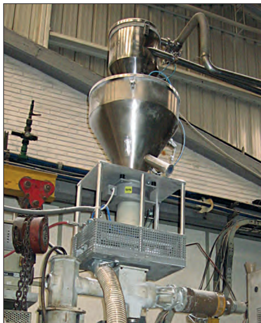
設置例：原料供給口に設置された金属除去装置 (旧バージョン)
