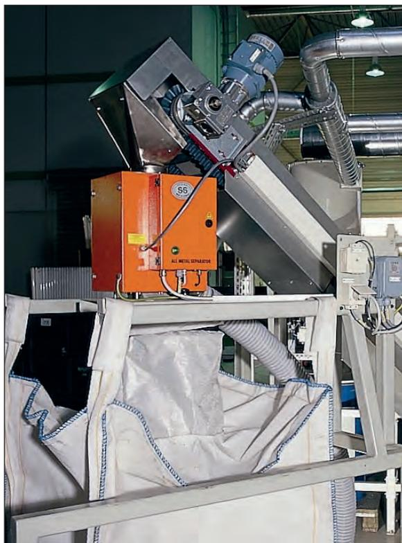
設置例：プラスチック粒の品質管理に使用される金属除去装置RAPID COMPACT
