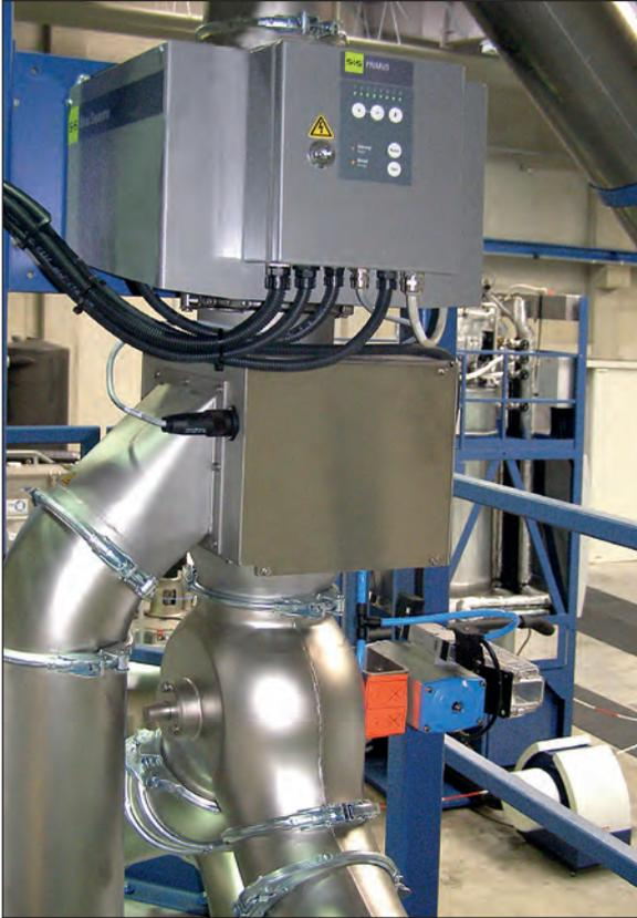
設置例：PET再生材の品質管理に使用される金属除去装置
